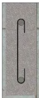
شکل ۸-۲۳- نمونه ای از اجرای تیر بنایی مسلح
